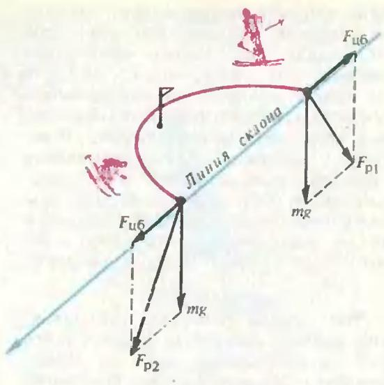
Рис. 12. Равнодействующие сил тяжести и центробежной в начале и в конце дуги:  $F_{p2} > F_{p1}$
