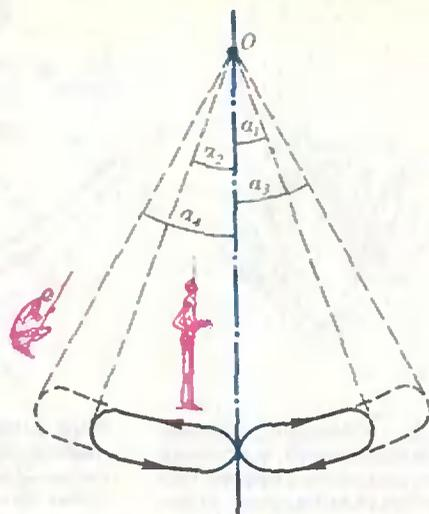
Рис. 11. Движение центра тяжести при раскачивании на качелях.
