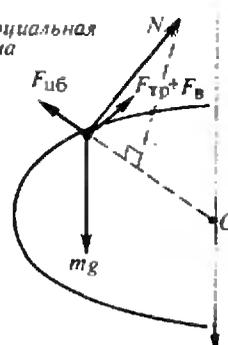
Рис. 2. Инерциальная и неинерциальная системы отсчета. В неинерциальной системе на лыжника действует центробежная сила инерции. Здесь и далее на рисунках голубая прямая со стрелкой обозначает линию склона.
