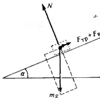
Рис. 1. Тело на наклонной плоскости:  $mg$  — сила тяжести,  $N$  — сила реакции опоры,  $F_{тр}$  и  $F_{в}$  — силы трения и сопротивления воздуха. Уравнение движения тела —
